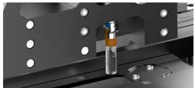
Identificazione provetta, lettura interna codice
